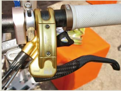
Víčko nádobky na horní straně páky je dnes standardem, někteří výrobci mají nádobku na dva šrouby s křížovou hlavou, Magura ovšem standardně používá Torx provedení. Zde je nádobka kolmo k řídítkům.
