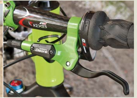
Víčko nádobky upevněné dvěma šroubky s křížovou hlavou, nedělitelná objímka řídítek a nádobka umístěná souběžně s řídítky. Zde navíc dostatek prostoru pro domácí „tuning“ v zelené barvě.
