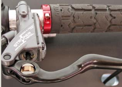
Víčko nádobky na horní straně páky je dnes standardem, někteří výrobci mají nádobku na dva šrouby s křížovou hlavou, Magura ovšem standardně používá Torx provedení. Zde je nádobka kolmo k řídítkům.
